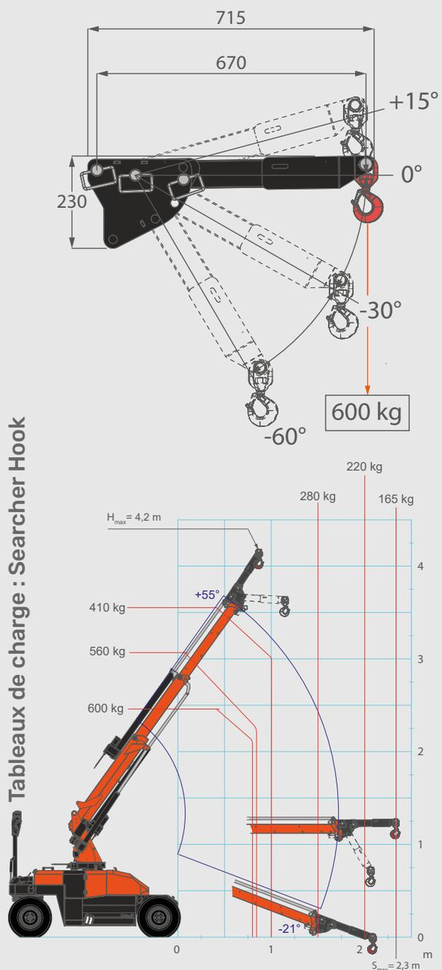
Tableaux de charge : Crochet Manipulateur
