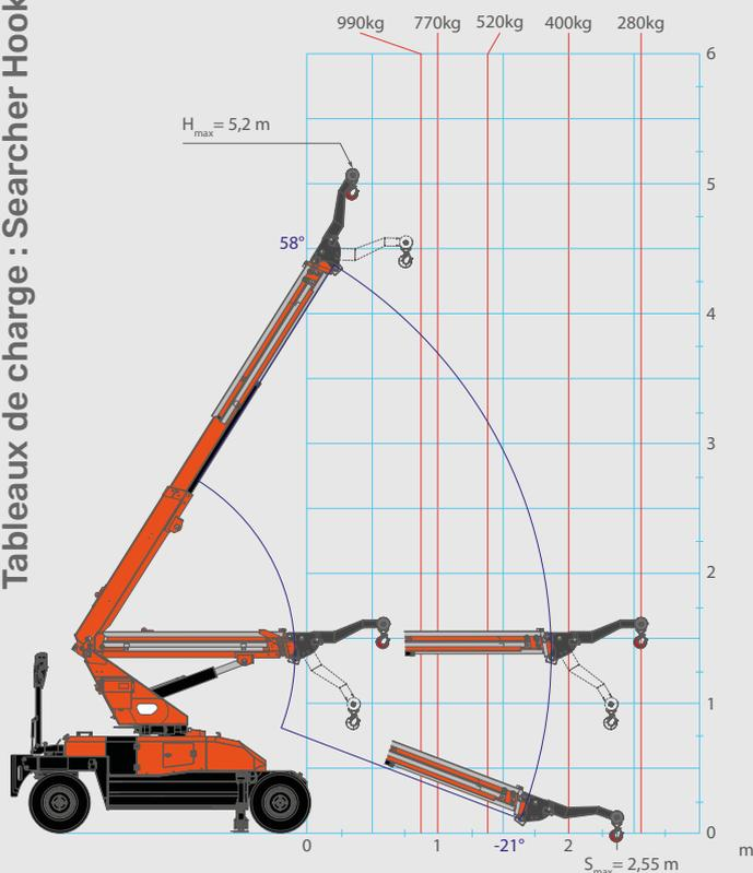
Tableaux de charge : Crochet Manipulateur
