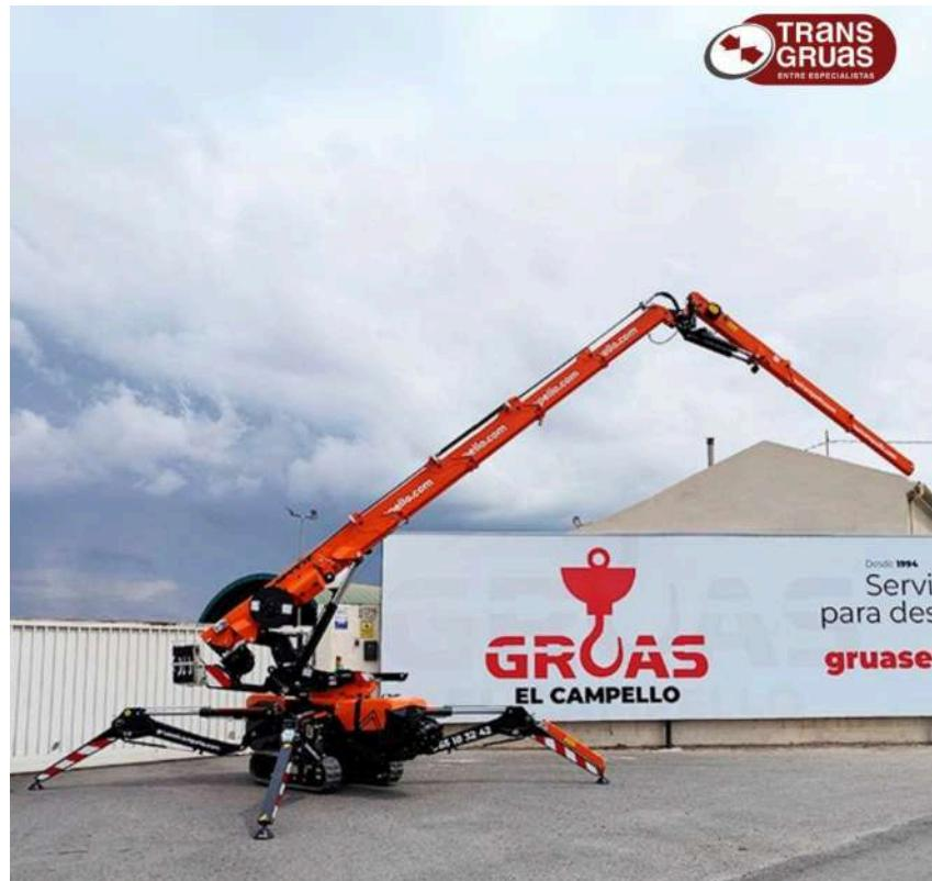
La Jekko SPX532 es una minigrúa sobre orugas que destaca por su compacidad y gran rendimiento. A pesar de su reducido tamaño, es capaz de levantar cargas de hasta 3.200 kg y alcanzar una altura máxima de trabajo de 17 metros, lo que la convierte en una solución extremadamente versátil para trabajos en espacios reducidos o de difícil acceso.
