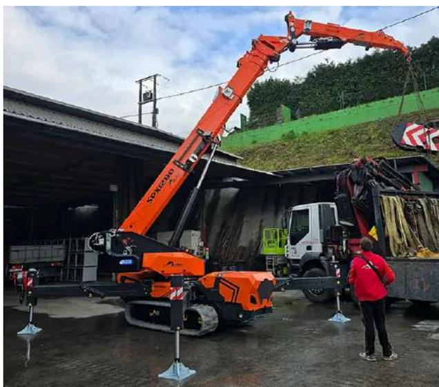
Lo que hace especialmente destacable a esta minigrúa es su **sistema de control avanzado**, que permite seleccionar entre cinco configuraciones diferentes: pick & carry, grúa, estabilizadores, barras transversales y traslación. Además, cuenta con un limitador electrónico inteligente y control de estabilidad que muestra la información de manera visual y clara a través de su display gráfico.
